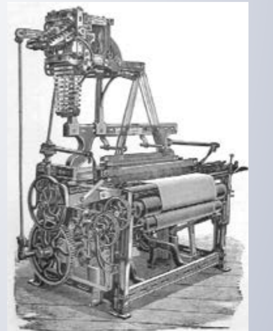
Şekil 1: Edmund Cartwright'in Mekanik Dokuma Tezgahı (Kaynak: https://en.wikipedia.org/wiki/Power_loom )
